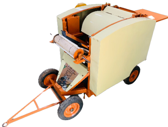
चित्र 4: विकसित यांत्रिक बहु-बास्ट रेशेदार फसल-आधारित रिबन एक्सट्रैक्टर (डेकोर्टिकेटर)
